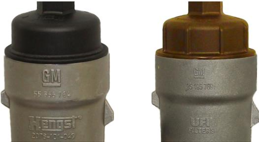
Les moteurs GM de 1,4 litre peuvent être munis d'un boîtier et d'un bouchon de filtre à huile de marque HENGSTMD ou UFIMD. Chaque boîtier est différent et nécessite un filtre de conception spécifique pour bien fonctionner. **Les filtres pour les différents boîtiers de filtre à huile ne sont pas interchangeables et, s'ils sont mal utilisés, ils pourraient entraîner de gros dégâts au moteur.**
