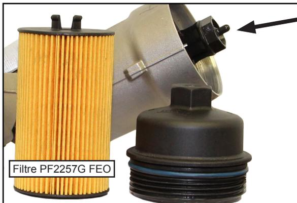
Le boîtier HENGST<sup>MD</sup> est muni d'une soupape de dérivation située dans le montant du boîtier.
