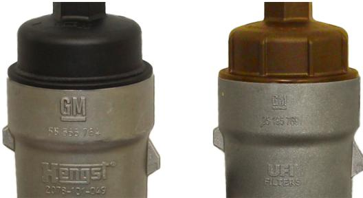
Los motores GM 1.4L pueden estar equipados con una carcasa y una tapa de filtro de aceite HENGST® o un filtro de aceite fabricado por UFI®. Cada carcasa es única y requiere un filtro diseñado específicamente para funcionar correctamente. **Los filtros para las diferentes carcasas de aceite no son intercambiables y, si se usan incorrectamente, pueden producirse graves daños al motor.**
