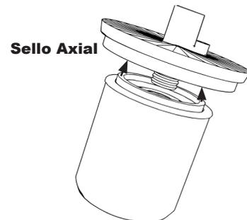
La composición química de los aceites de hoy en día y las altas temperaturas de funcionamiento de los motores son dos variables que pueden afectar a la junta a lo largo del tiempo. Más material de junta equivale a una mejor resistencia química al aceite y altas temperaturas en el motor. Esto significa que la junta mantendrá la compresión a lo largo de la vida útil del filtro.
