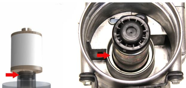
Otra diferencia notable en el diseño es la membrana que cubre el medio del filtro OE. Como separadores de combustible/agua, ambos filtros cumplen con la función de impedir que el contenido de agua que se encuentra en todos los combustibles diésel entre en el sistema. Ambos filtros dependen de las diferentes propiedades físicas del agua y el combustible para lograr esta función.
