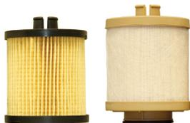
Una vez instalados, ambos filtros sellan radialmente, pero el punto de sellado es diferente para cada uno. El filtro OE se asienta y sella en el diámetro interior del reborde en la caja del filtro. Este diseño requiere un área extendida en la parte inferior del filtro que se ajusta dentro del área del reborde. El sellado radial se forma cuando el filtro es instalado.
