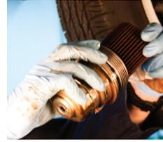
**8** Limpie tanto el filtro de la tapa de la carcasa y la carcasa. Examine para determinar daños tales como grietas, roturas, o roscado dañado. Compruebe los asientos de junta tórica, asegurándose de que estén en buen estado y limpios. Reemplace los componentes dañados si es necesario. Mientras retira la junta tórica usada, observe su colocación correcta en la tapa o la carcasa.
