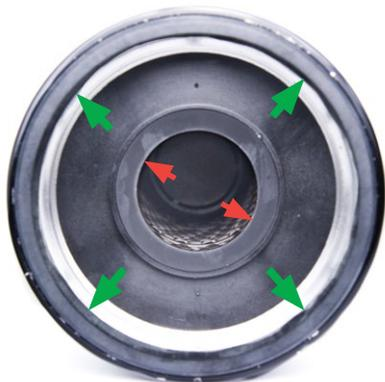
Nous indiquons les endroits du joint extérieur (flèches vertes) et du joint intérieur (flèches rouges) sur lesquels il faut appliquer une légère couche d'huile moteur propre avant d'installer le filtre.
