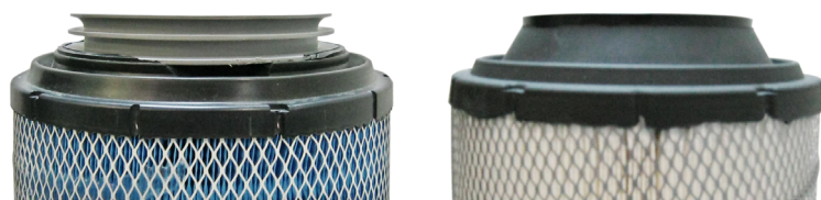
Vue du récupérateur d'eau dans le haut des filtres (le nôtre est à droite). L'air sale et mouillé circule par l'entrée d'air dans le boîtier, au-dessus de la cornière sur le filtre et par le coin. Ceci permet d'éliminer l'eau de l'air filtré et de la diriger vers le trou de vidange dans le fond du filtre.
