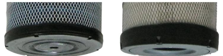
El agua es canalizada hacia afuera del flujo de aire, cae hacia la parte inferior del filtro, hacia el agujero de drenaje, y sale de la caja. El nuevo diseño WIX del agujero de drenaje (a la derecha) es notablemente más largo que el del equipo original. El rendimiento y la protección del motor no están comprometidos. La caja del equipo original se encuentra en el exterior y expuesta a la lluvia.
