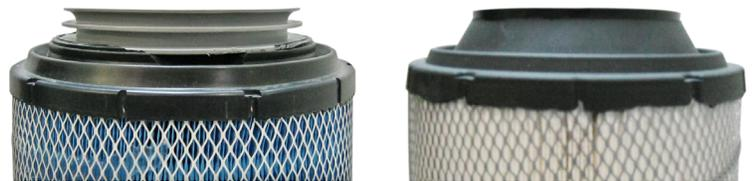
Una vista del separador de agua en la parte superior del filtro (el nuestro, a la derecha). El aire sucio-húmedo fluye a través de la entrada de aire en la caja, hacia arriba por el ángulo sobre el filtro, y por encima de la esquina. Esto ayuda a canalizar el agua hacia afuera del aire, cayendo a la parte inferior del filtro, hacia el agujero de drenaje.
